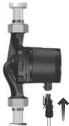
Рис. 10 Подключение к электросети
